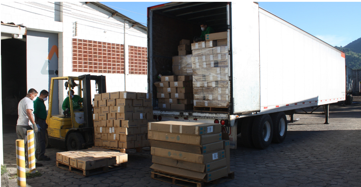
Fotografía 4. Accesos amplios, que permitan maniobrar adecuadamente.
